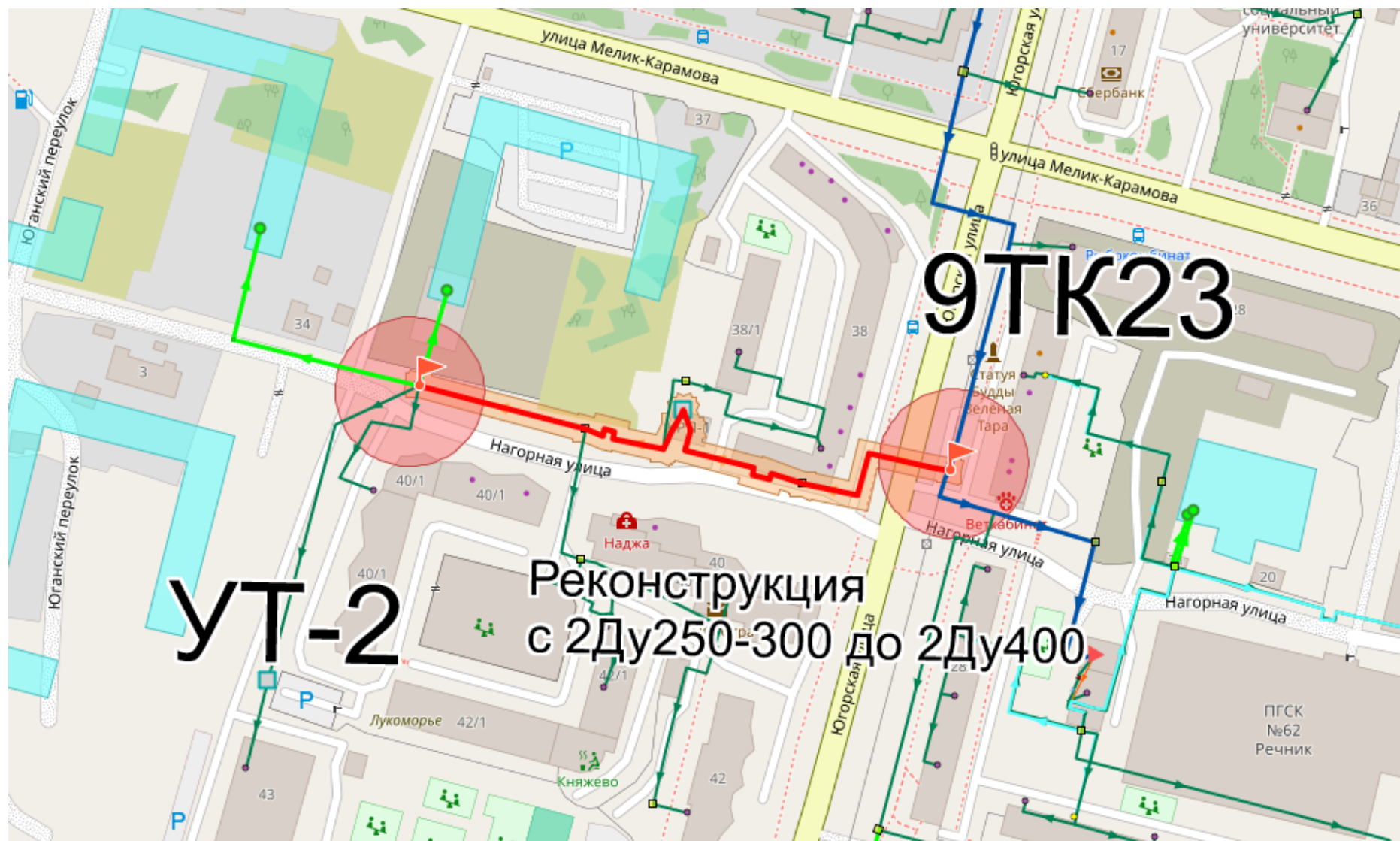
Рисунок 5.37 – Схема расположения реконструируемого участка от 9TK23 до УТ-2
